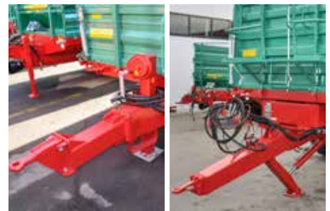
» Stützfuß in verschiedenen Varianten – mechanisch, hydraulisch, Y-Variante oder Sattelstützwinde teleskopierbar mit zwei Geschwindigkeiten » Oben- oder Untenanhängung
