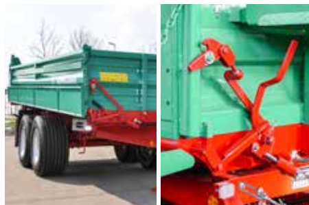
» Hydraulische Pendelwandentriegelung » Seitliche Rübenrutsche (zur Entladung von Kartoffeln und Zuckerrüben)
