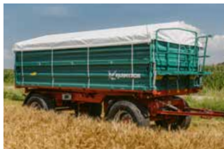
» Ein sicheres Podest zur Kontrolle des Befüllungsvorgangs sowie eine reißfeste Rollplane für den Transport
